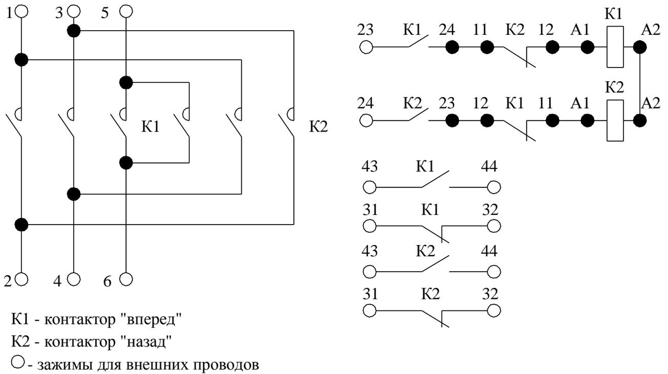
Рисунок Г 8 - Контактор реверсивный с 4«з» + 4«р» контактами вспомогательной цепи
