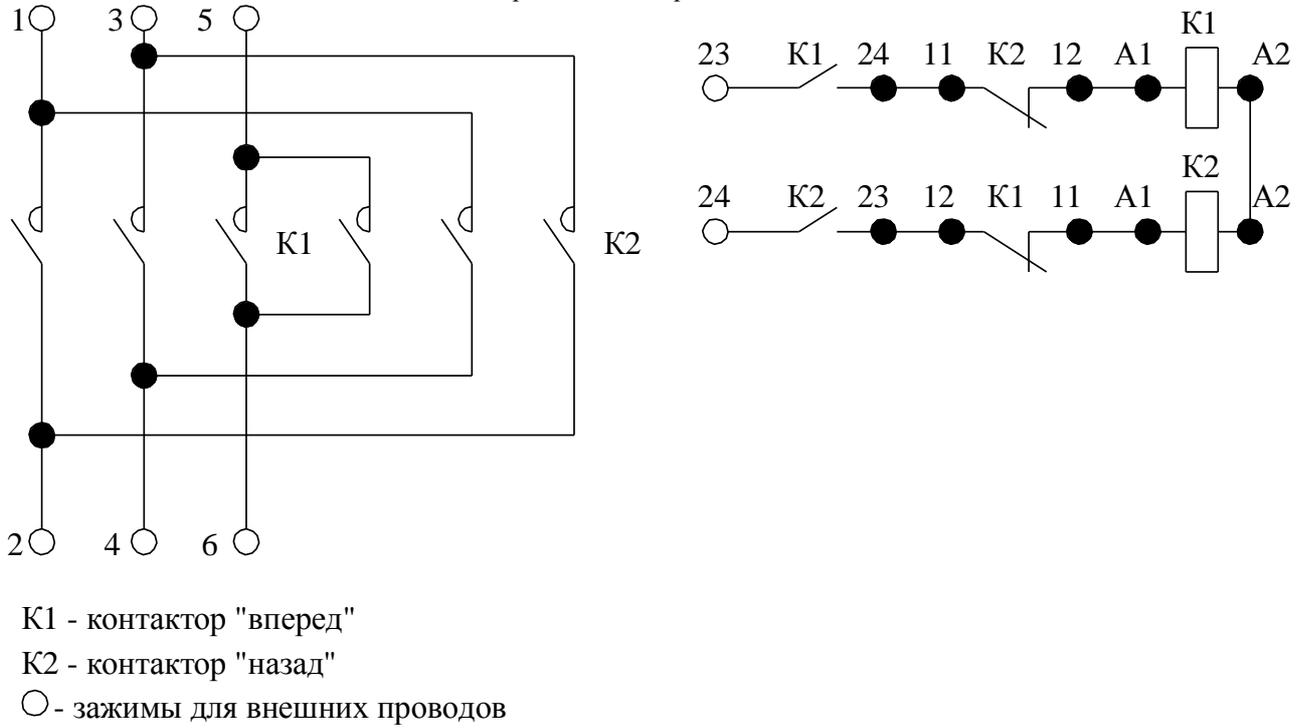
Рисунок Г 7 - Контактор реверсивный с 2«з» + 2«р» контактами вспомогательной цепи
